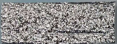
EN-30AL 片面アルミ蒸着 3mm厚
