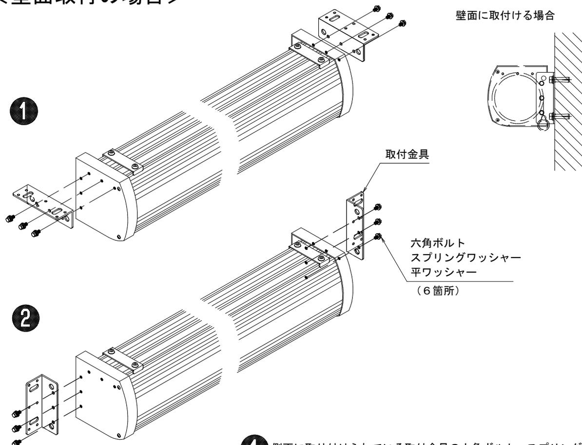
**1** 側面に取り付けられている取付金具の六角ボルト・スプリングワッシャー・平ワッシャー（6箇所）を外して下さい。
