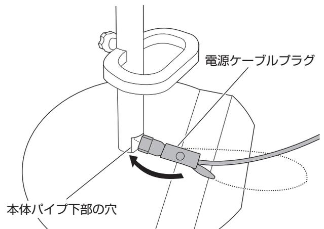
5. 電源ケーブル配線穴から配線補助チェーンを引き出します。
