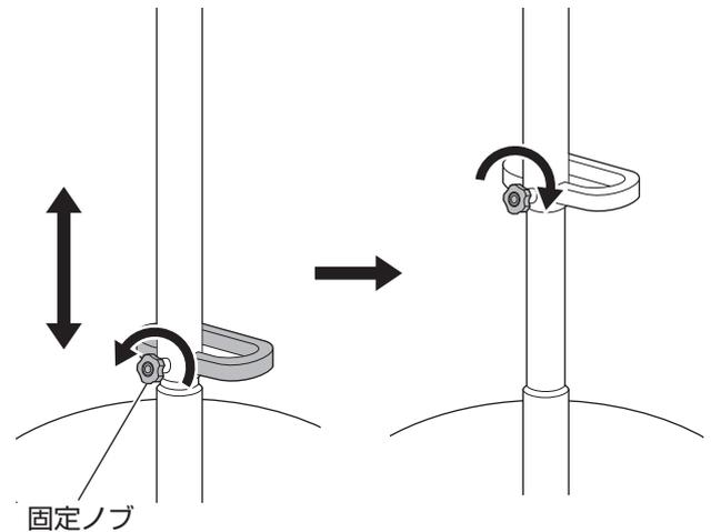
2. 昇降レバー下部にスタンド位置固定金具(パイプクランプ)を取り付けます。
