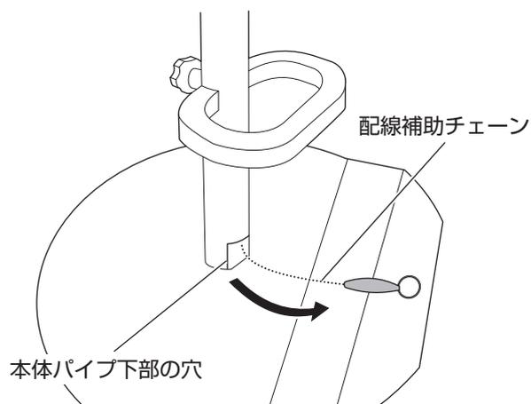
3. 配線補助カバーを開け、内部のスナップメスに配線補助チェーンのリングを引っ掛け、映像ケーブルの端子部を入れてスナップを留めます。
