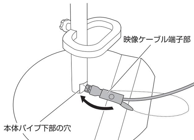
5. 映像ケーブル配線穴から配線補助チェーンを引き出します。
