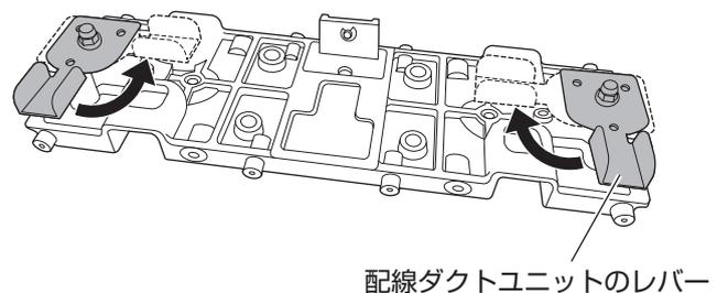
4. 配線ダクトユニットを、PJ 取付金具(小)のスリット部にスライドしてはめ込み固定します。
