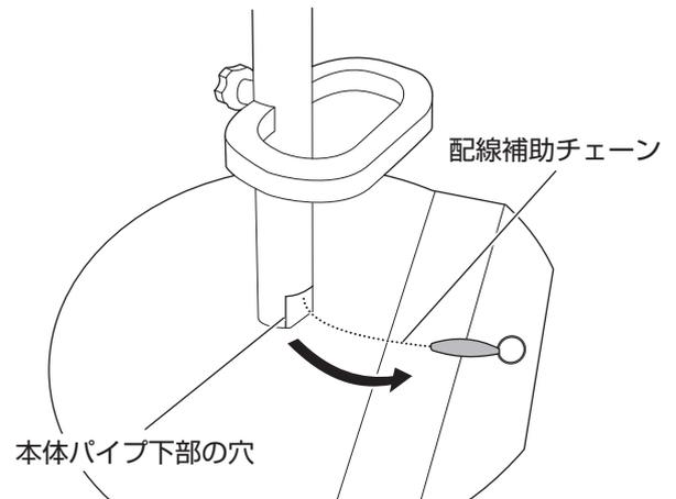
3. 配線補助カバーを開け、内部のスナップメスに配線補助チェーンのリングを引っ掛け、電源ケーブルのプラグを入れてスナップを留めます。
