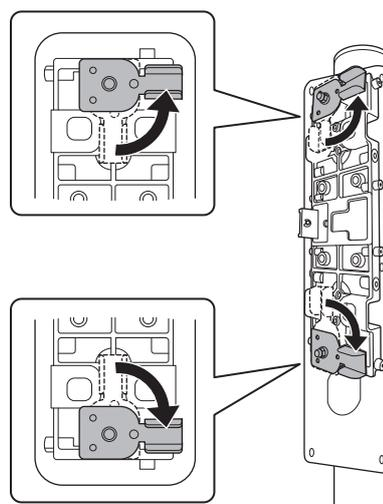
6. 手順2で外した固定ネジ(M4×10) 2個でレバーを固定します。
