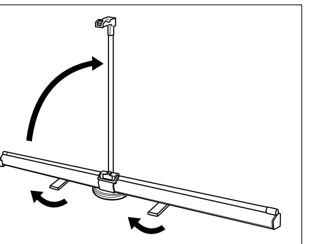
4. 安全装置（緑色）を90°回転して解除し、開閉レバーを作動状態にする
