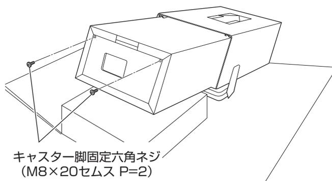
2. キャスター脚のだるま穴を、支柱底面上部のキャスター脚固定ネジのねじ山に引っかけます。
