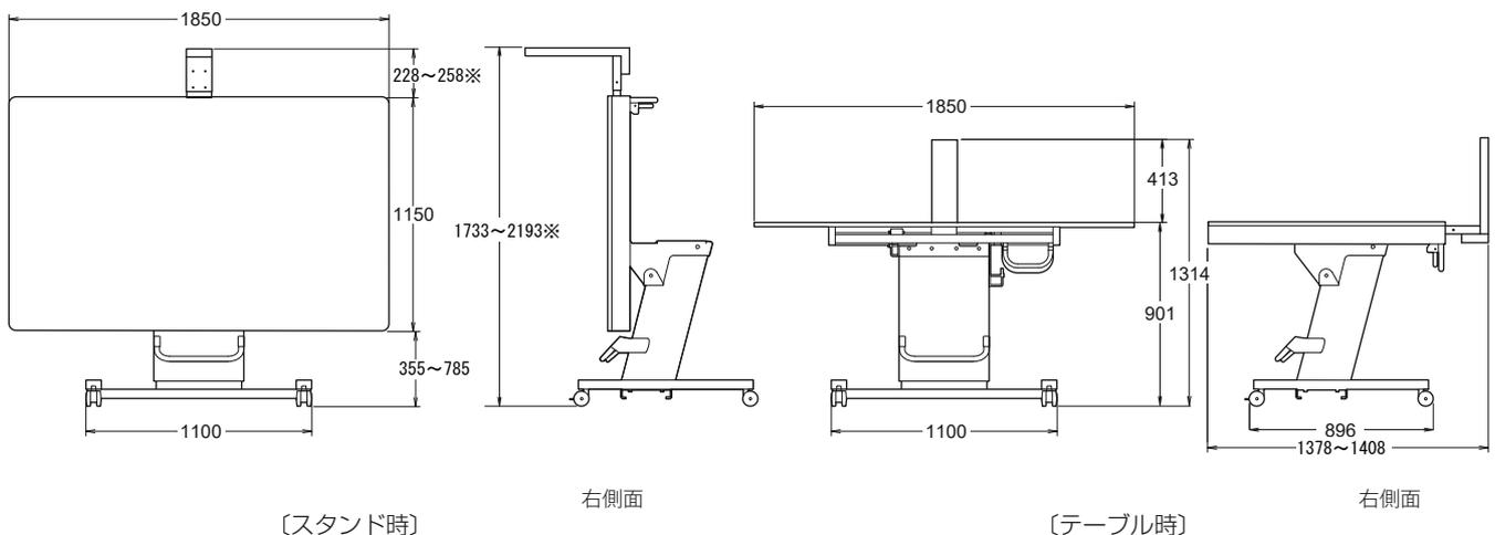
※取り付けるプロジェクターによって高さは変動します。
